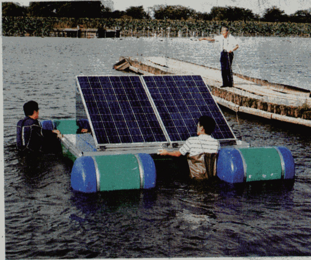
瓢湖に設置されたナノバブルを発生させる装置＝14日、阿賀野市
